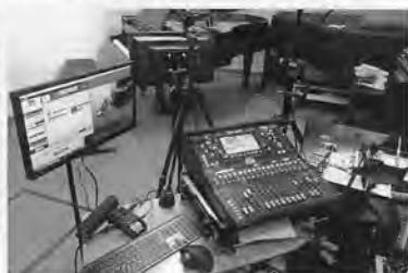
大阪会場の車回りの機材。コンソールは Allen & Heath「SQ5」を使用
